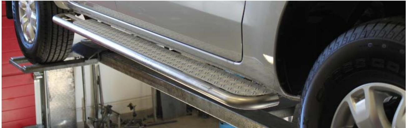
Schwellerrohre / *side bars* (BT/12, Ausf. A)
