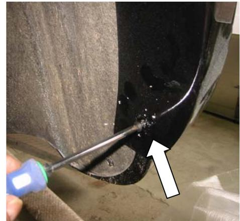
1. Verbreiterungsteile am Kotflügel platzieren und anpassen. Gegebenenfalls Befestigungslöcher für die gelieferten Blechschrauben im Kotflügel bohren und verschrauben. Teile wieder abnehmen.
