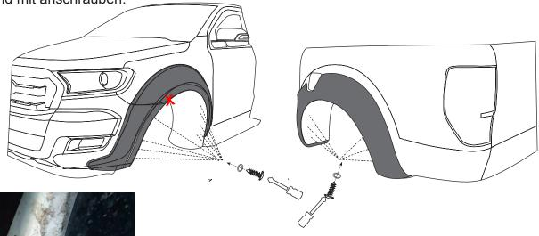
Für die rot markierte Bohrung muß der beiliegende Metallbügel von innen auf den Kotflügelrand geschoben werden. Nun kann die Schraube durch die Bohrungen in der Verbreiterung eingeschraubt werden.
