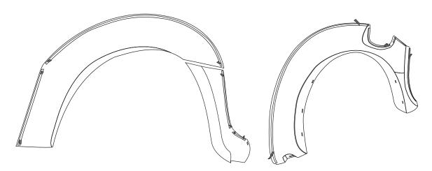
5. Positionieren Sie die Kotflügel korrekt und drücken Sie die Teile leicht an. Befestigen Sie nun den Kotflügel indem Sie die <u>beiliegenden</u> Schrauben und Unterlegscheiben in den Löchern wieder einsetzen und fest anschrauben. Gegebenenfalls Schmutzfänger auf dem Kotflügel aufsetzen und mit anschrauben.
