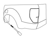
3. Drücken Sie nun die Kotflügel verkleidung vom Kotflügel und schieben
