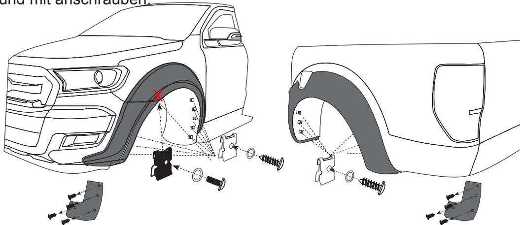
9. Positionieren Sie die Kotflügel korrekt und drücken Sie die Teile leicht an. Überprüfen Sie die korrekte Position und ob der Keder Gummi gut sitzt und ziehen Sie dann das restliche Schutzfolie ab. Schrauben Sie nun alle Schrauben fest.
