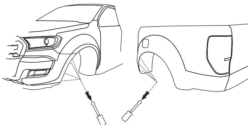
5. Drücken Sie nun die Kotflügel-Verkleidung vom Kotflügel und schieben Sie die Klemmen von innen über den Kotflügelrand, so dass die Bohrungen bündig sind. Achten Sie darauf dass die Klemmen den Korrosionsschutz nicht beschädigen.
