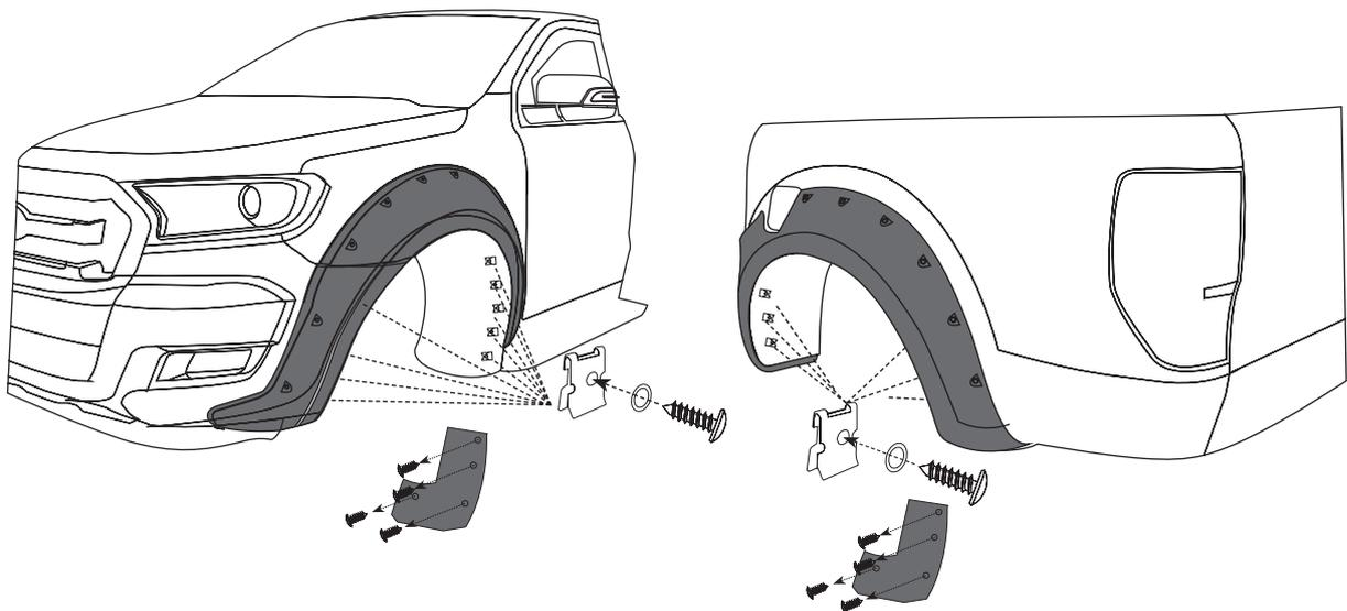
6. Überprüfen Sie die korrekte Position und ziehen Sie dann die restliche Schutzfolie ab. Optional kann vor dem Abziehen der Schutzfolie mit einem Pinsel Primer entlang der Klebekante aufgetragen werden. Damit wird die Klebefestigkeit erhöht.
