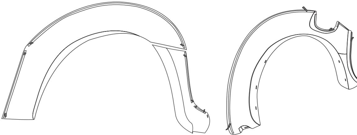
5. Positionieren Sie die Kotflügel korrekt und drücken Sie die Teile leicht an. Befestigen Sie nun den Kotflügel indem Sie die beiliegenden Schrauben und Unterlegscheiben in den Löchern einsetzen und fest anschrauben. Gegebenenfalls Schmutzfänger auf der Kotflügelverbreiterung aufsetzen und anschrauben.
