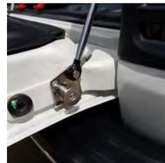
5. Setzen Sie den Dämpfer an der Heckklappe an und schrauben Sie diesen mit der beiliegenden Schraube fest.
