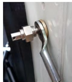
2. Ätauschen Sie die Unterlegscheibe und schrauben Sie das Fangseil mit dem Dämpferhalter fest.
