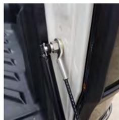
3. Setzen Sie den Dämpfer am Fangseilhalter an und sichern Sie diesen mit dem beiliegenden Federstift.
