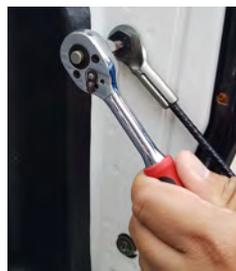
1. Fangseilschraube lösen.
