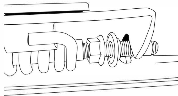
**4.2 Stellen Sie das Längsspiel ein indem Sie die Schraube (s. Abb D.) anziehen.**
