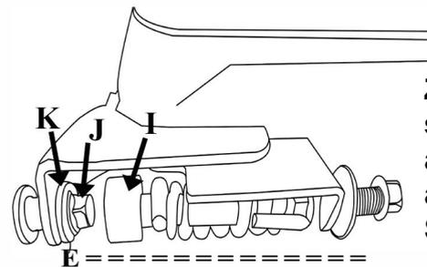
**Ziehen Sie Schraube E solange an bis die Buchse an der Unterlegscheibe (K) anschlägt und den Schraubekopf (J) bedeckt.**
