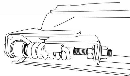
**4.4 Ziehen Sie abschließend Schraube (L) an. Kontern Sie dabei Schraube (E) in Position (N)**
