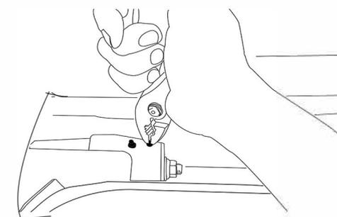
5. Schließen Sie die Heckklappe und bringen Sie den Gegenhalter wie abgebildet an. Sollte Ihr pickup einen Gummi Stopper haben, dann in Position Q befestigen. Schrauben Sie ihn anschließend mit der Original Schraube (P) fest. Fehlt diese nutzen Sie die beiliegende Schraube
