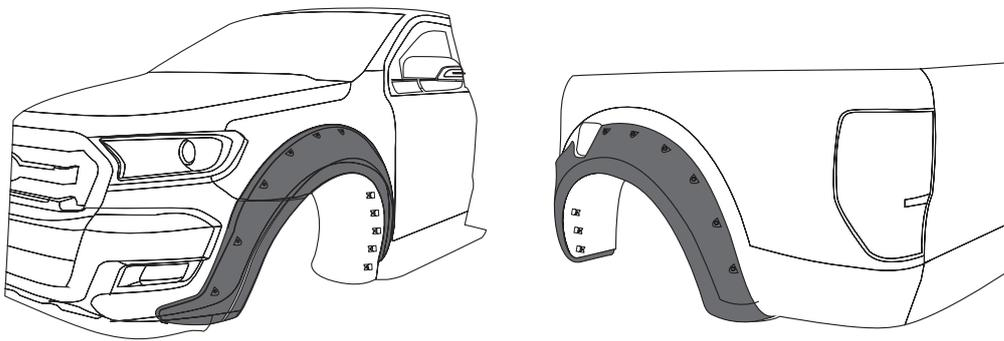
8. Befestigen Sie nun den Kotflügel indem Sie die beiliegenden Schrauben in den Löchern einsetzen und leicht anschrauben. Setzen Sie auch die mit X markierte Klemme ein. Gegebenenfalls Schmutzfänger unter der Kotflügel-Verbreiterung aufsetzen und mit anschrauben.
