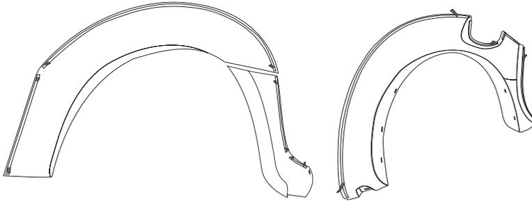
7. Positionieren Sie die Kotflügel korrekt und drücken Sie die Teile leicht an. Überprüfen Sie die korrekte Position und das der Keder Gummi gut sitzt
