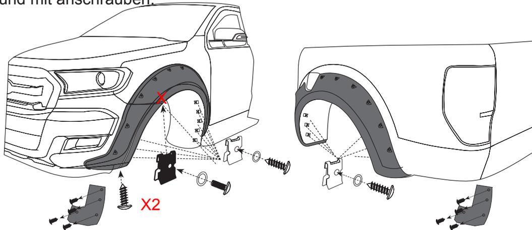
9. Positionieren Sie die Kotflügel korrekt und drücken Sie die Teile leicht an. Überprüfen Sie die korrekte Position und ob der Keder Gummi gut sitzt und ziehen Sie dann das restliche Schutzfolie ab. Schrauben Sie nun alle Schrauben fest. Schrauben Sie abschließend die Schraube X2 in die Plastikstosstange ein.
